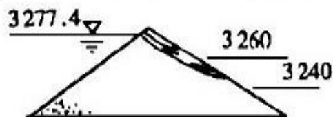
渗漏管涌(内部冲蚀)阶段
